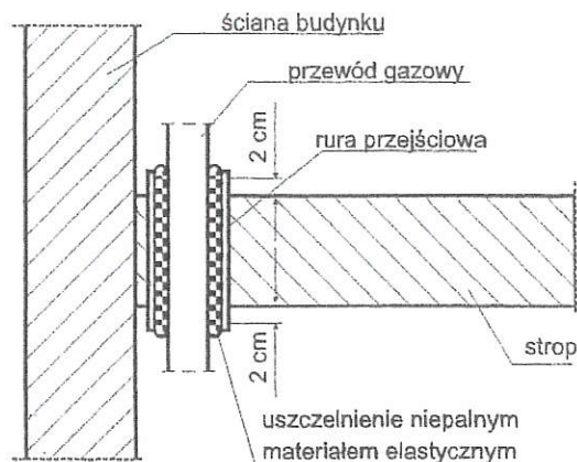
Sposób uszczelnienia przewodu gazowego przy przejściu przez strop
